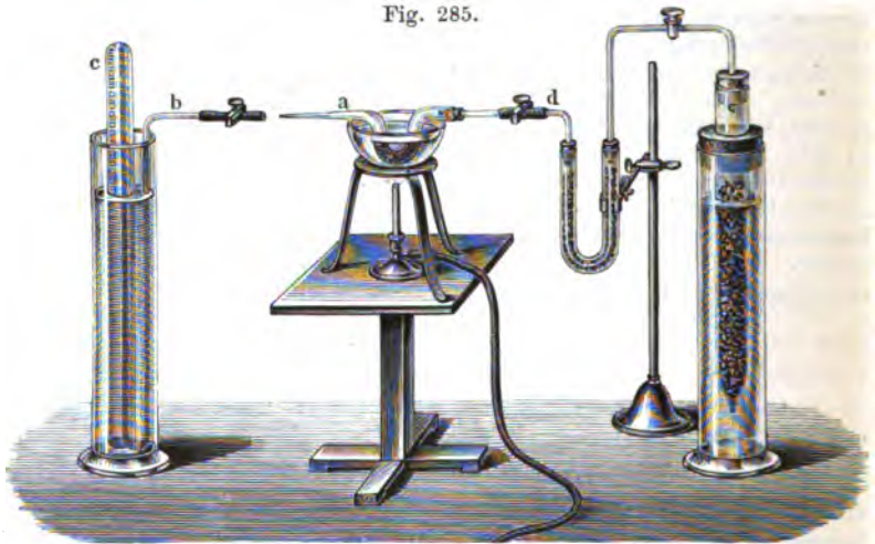
Beladung von Palladium mit Wasserstoff nach Wöhler.
